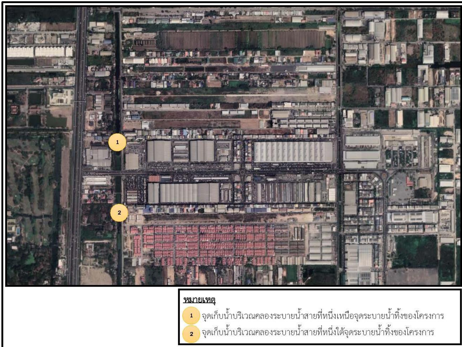
รูปที่ 3-7 แสดงการเก็บตัวอย่างน้ำผิวดิน
